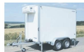
Fr. 7980.– GG 2700kg inkl. Kühlgerät, +2°C - +10°C, Wände und Boden 60mm isoliert, 4 Stützen
