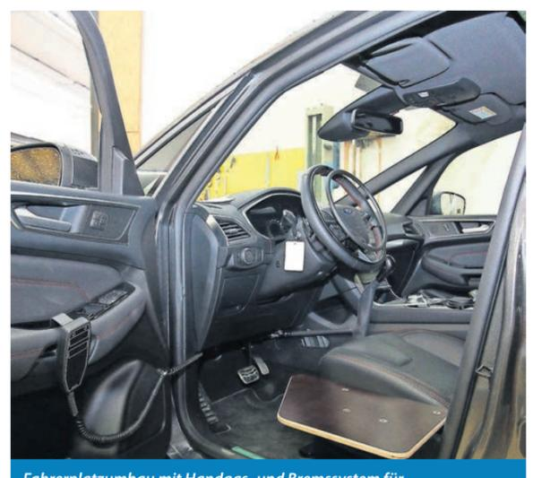
Fahrerplatzumbau mit Handgas- und Bremssystem für einen Rollstuhlfahrer
