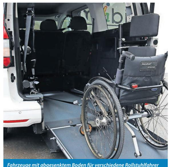
Fahrzeuge mit abgesenktem Boden für verschiedene Rollstuhlfahrer
